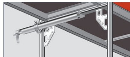
Blitz-Anker: Eingehängt unter dem U-Profil des Stellerahmens und befestigt mit einer Normalkupplung.
