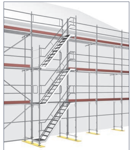
Diagonalführung, turmartig in Zickzackform oder durchlaufend
