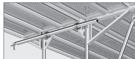
Durchgehender Gerüsthalter: Befestigt mit zwei Knotenblechkupplungen – ideal bei Konsolanschluss.
