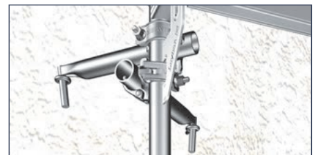
V-Anker: Ermöglicht die Verwendung kurzer Gerüsthalter und die Aufnahme hoher Kräfte parallel zur Fassade.
