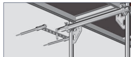
Durchgehender Gerüsthalter (in Verbindung mit WDVS-Anker): Befestigt mit zwei Normalkupplungen.
